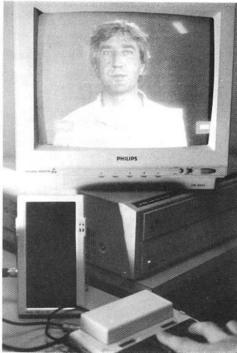
Fig. 2 - Détail des sorties : - vidéodisque/moniteur - plage tactile vibrante et affichage lumineux simulant la plage tactile.
